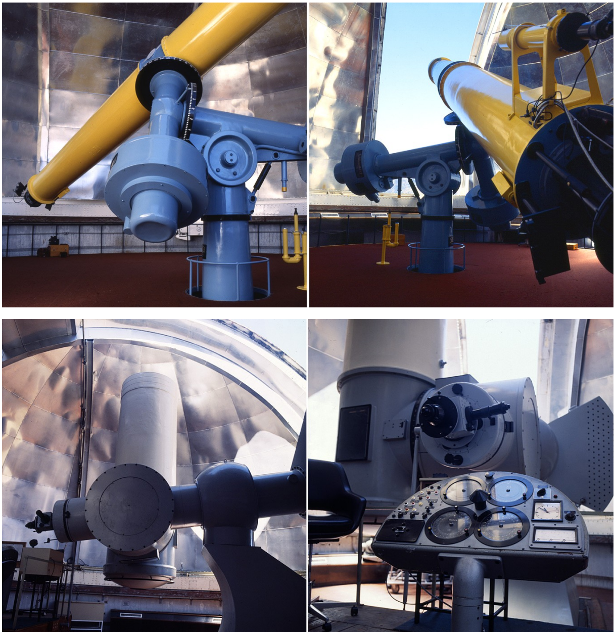
Oben: der 65 cm Zeiss Refraktor mit 10,5m Brennweite und unten der 1 m Coudé Reflektor von Zeiss mit seinem Steuerpult
